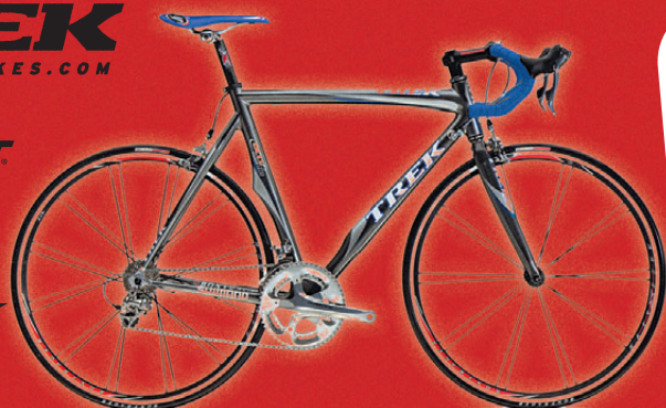
Madone™ 5.9 Frame DCV 110 Carbon Vork Bontrager Race XXX Lite Wielen Bontrager Race X Lite Aandrijving: crankstel Shimano Dura-Ace 53/39 achterderailleur Shimano Dura-Ace
